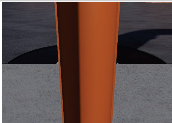
Рисунок 5 Гладкостенная труба, проходящая через бетонную плиту
