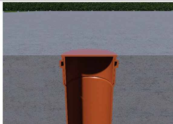
Рисунок 4 Раструб трубы, смонтированный вровень с плитой
